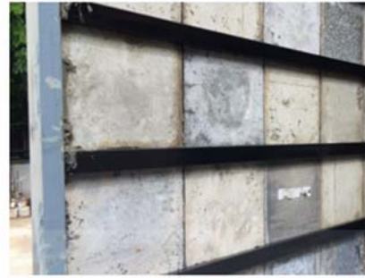
ด้านหลังของผนังจำลองที่ติดตั้งแผ่นซีเมนต์บอร์ดจากกากกาแฟ
